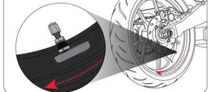
Attention : le sens d'installation du capteur indiqué par la flèche doit être cohérent avec le sens de rotation du pneu.
